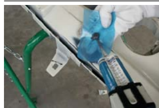
Нанесение Tander для пластика на формовочную пленку Tander.
