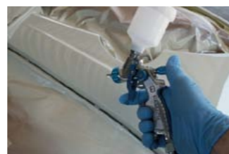
Распыление краски согласно рекомендациям производителя.
