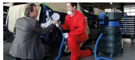
Одноручная орбитальная шлифовальная машина HD 98, 5 мм – 150 мм подложки 000214
