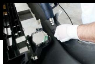
Моделирование повреждения при помощи фена.
