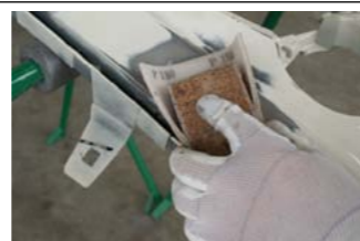
Зачистка концов при помощи Colad Soft Flex P180.
