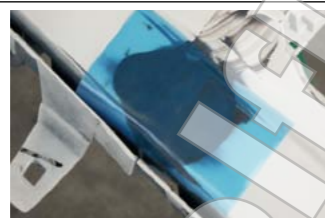
Размещение формовочной пленки с Tander для пластика на внешней стороне. Удалите после высыхания.
