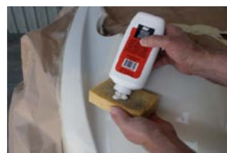
Очищение прилегающей зоны при помощи матирующей пасты Colad.
