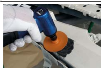
Шлифование внешней стороны при помощи Hamach HP 80 и Colad Spin & Trim.
