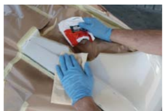
Очищение покрытия при помощи салфеток Colad перед распылением краски.
