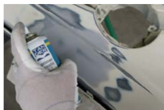
Распыление праймера Tander Primer Plastic 40.30. Подождите 10 минут для высыхания.
